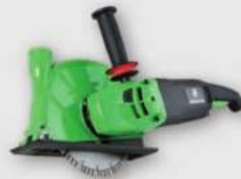
ETR 230 2.600 W; 6.500 min -1 ; Ø 230 mm; max. Schnitttiefe 65 mm
