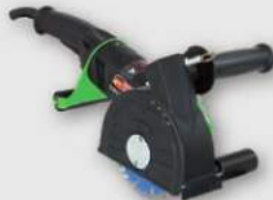
EMF 125 1.400 W; 7.000 min -1 ; Ø 125 mm; 30 mm Tiefe; 30 mm Breite
